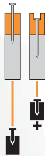
Quando se utiliza para clavar madera sobre acero o hierro hay que tener en cuenta que el grosor del metal no debe superar el diámetro del clavo que se utilice.
