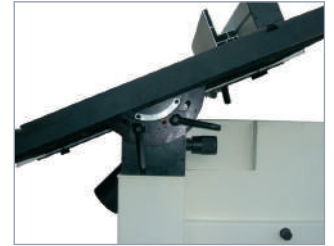
Inclinación de la mesa Table tilting Inclinaison de la table
