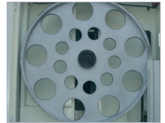
Volante superior Upper wheel Volant supérieur
