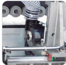
Grupo retesteador (doble disco) End cutting unit (two blades)
